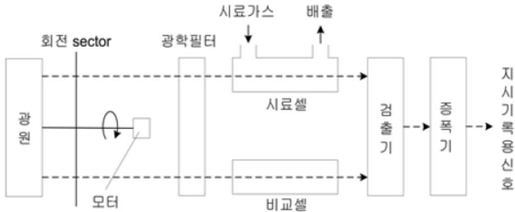
그림 1. 복광속 비분산적외선분광기의 구성 (예)
